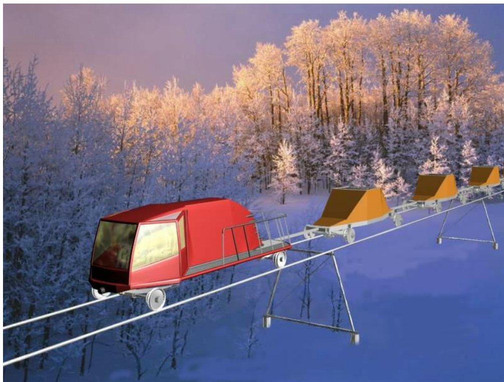
Рис. 2. Эшелон грузовых модулей для перевозки щебня
