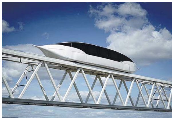
Рис. 2. Междугороднее пассажирское транспортное средство SkyWay — высокоскоростной (до 500 км/ч) 6-местный юнибус семейного типа
