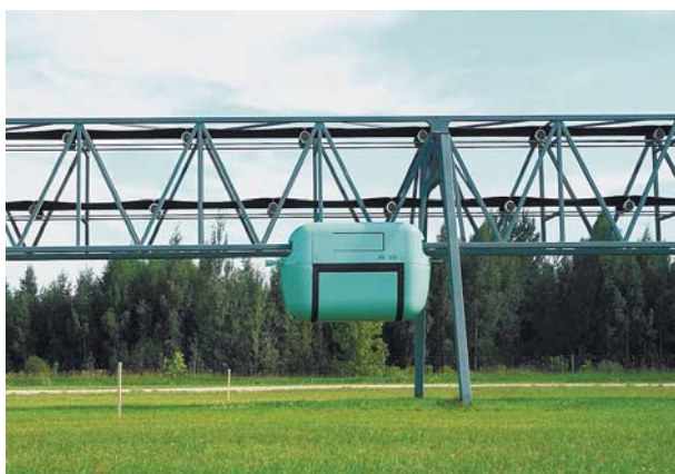
Рис. 3. Грузовое транспортное средство SkyWay — юнитрак
