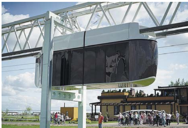
Рис. 1. Городское пассажирское транспортное средство SkyWay — подвесной квадирельсовый 48-местный юнибус. Марына Горка, 2019 г.
