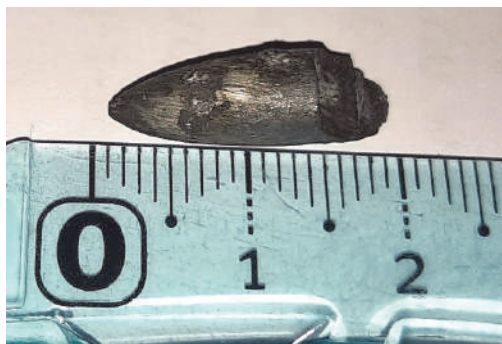
Рис. 14. Пуля, извлеченная из бетонного образца
