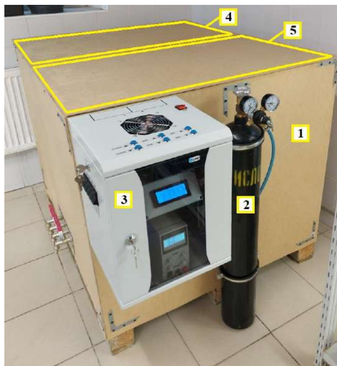
Рисунок 1 – Внешний вид установки (1 – контейнер с ёмкостями для культивации, 2 – газовый баллон с углекислотой, 3 – блок управления, 4 и 5 – крышки)
