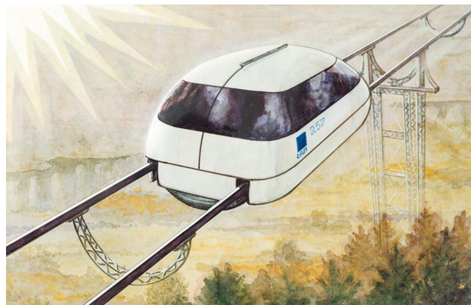
Рисунок 1.5 – Трасса НТЛ на высоких опорах (около 100 м)
