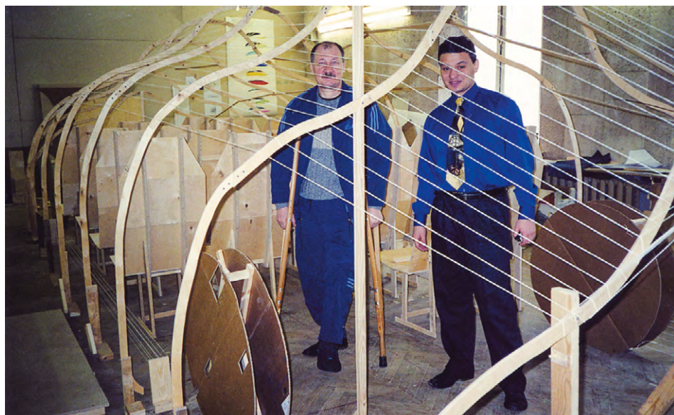
Работа над обводами высокоскоростного юнибуса масштаба 1 : 1, г. Москва, март 2001 г.
