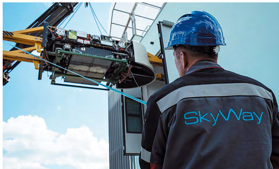
Испытания тяговых модулей бирельсового юнибуса U4-220, ЭкоТехноПарк, г. Марьино Горка, 2018 г.
