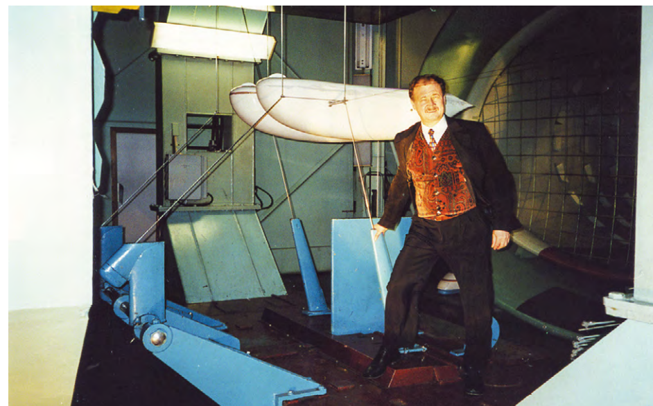
Продувка модели двухкорпусного юнибуса масштаба 1 : 5 в аэродинамической трубе, г. Санкт-Петербург, октябрь 2000 г.
