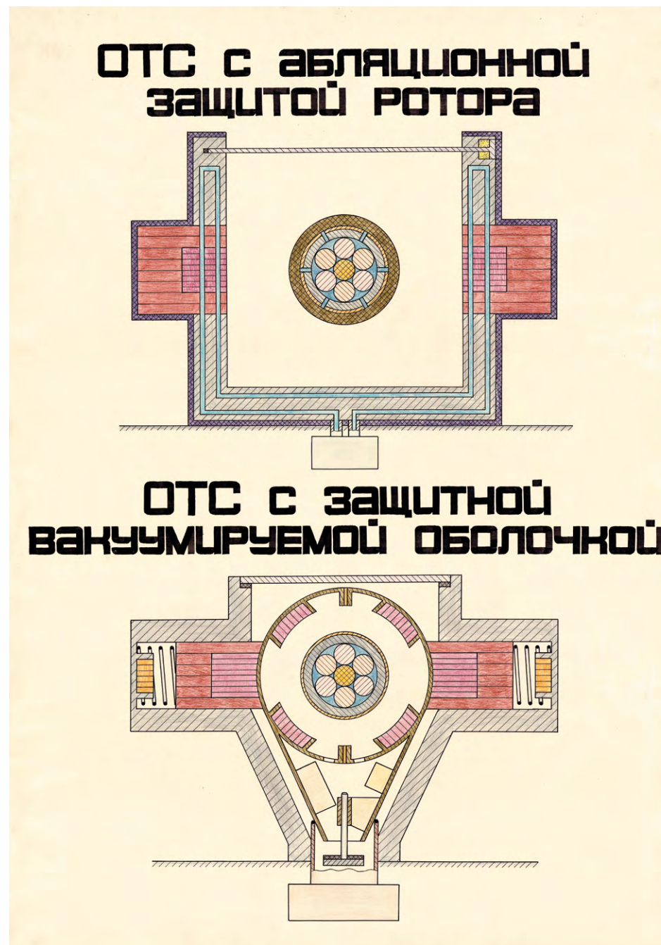
ОТС с абляционной защитой ротора и ОТС с защитной вакуумируемой оболочкой, 1974 г.
