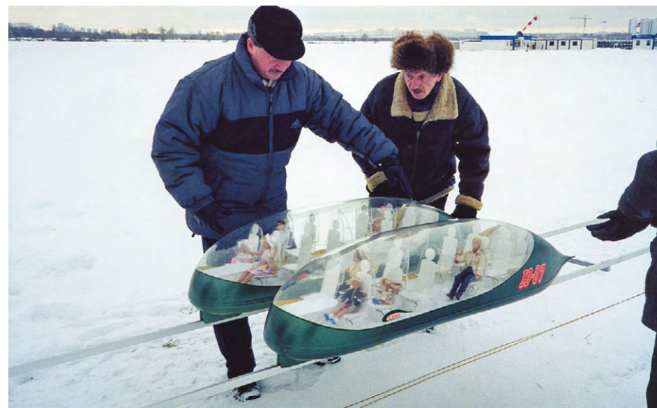
Первое испытание бирельсовой трассы и модели двухкорпусного юнибуса масштаба 1 : 5, аэродром Тушино, декабрь 2000 г.
