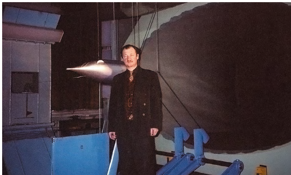
Продувка модели высокоскоростного юнибуса масштаба 1 : 5 в аэродинамической трубе, г. Санкт-Петербург, февраль 1996 г.
