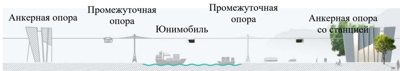
Рисунок 1 – Схематическое представление состава комплекса ЮСТ
