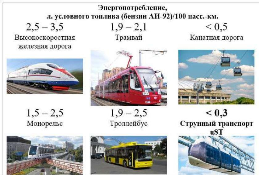
Рис.2. Удельный расход энергоресурсов различных видов транспорта
