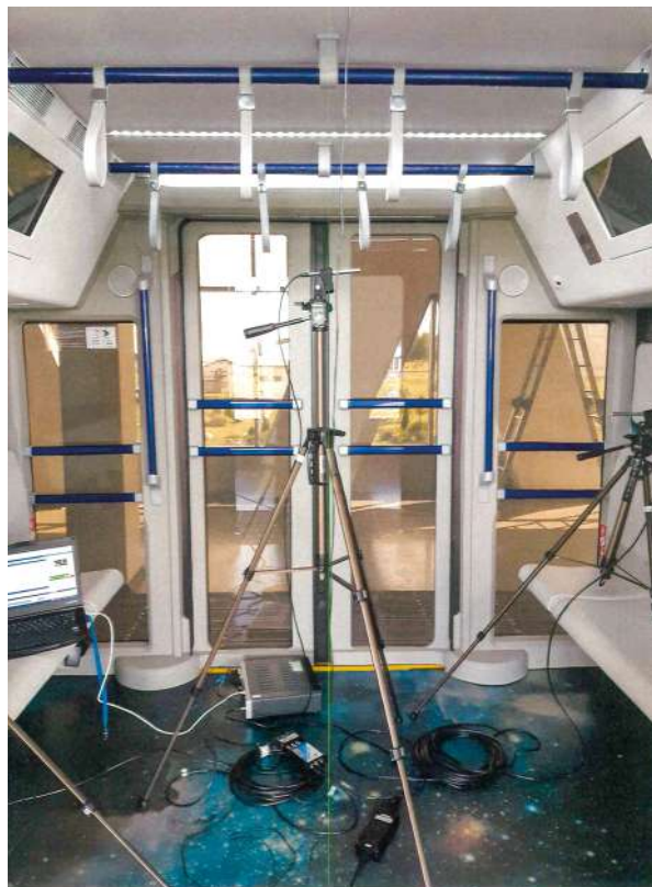
Рис. 10. Размещение микрофонов в салоне юнибуса
