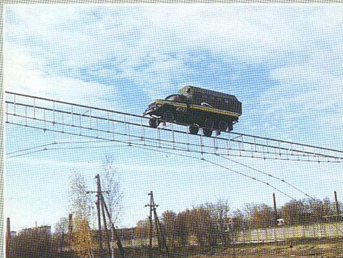
Автор СТС акад. А. Э. Юницкий в момент первого испытания системы (г. Озёры Московской обл., октябрь 2001 г.). В качестве транспортного модуля СТС использован грузовой автомобиль ЗИЛ-131, движущийся по путевой структуре
