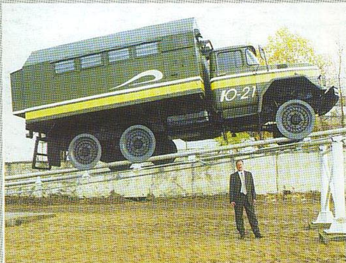
Автор СТС акад. А. Э. Юницкий в момент первого испытания системы (г. Озёры Московской обл., октябрь 2001 г.). В качестве транспортного модуля СТС использован грузовой автомобиль ЗИЛ-131, движущийся по путевой структуре
