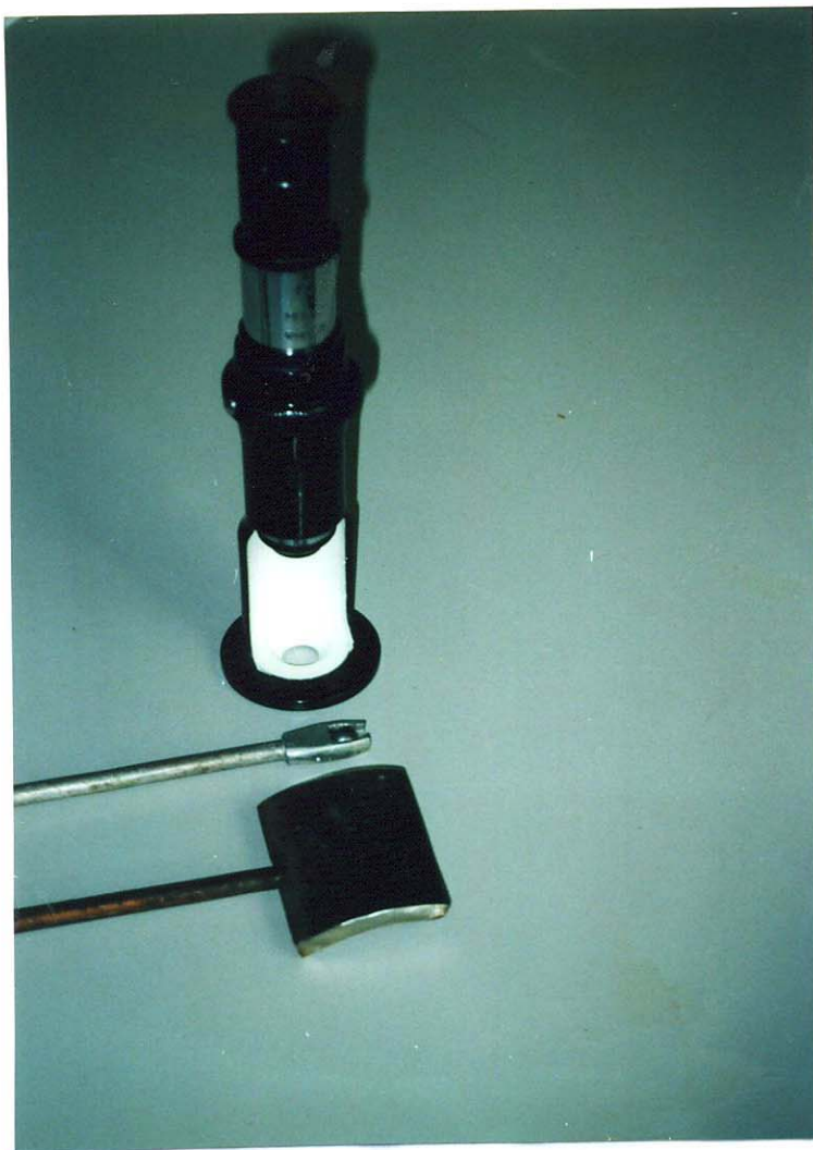
Рис. 2.3.1. Приспособление для измерения сравнительной твердости
