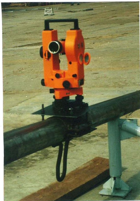
Рис. 2.2.2. Система крепления теодолита к головке рельса
