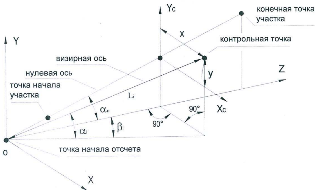
Рис. 2.2.1. Схема измерения полярных координат контрольной точки.
