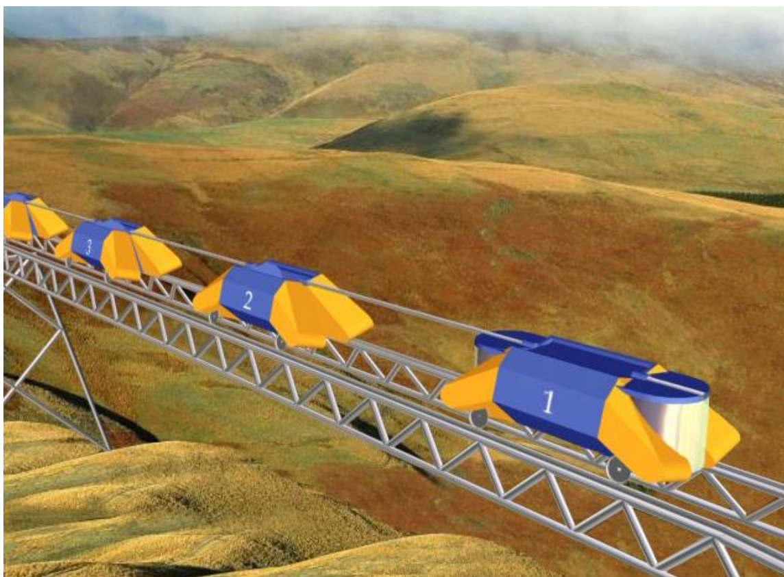
Рис. 2.4. Эшелон модулей для перевозки сыпучих грузов на трассе.
