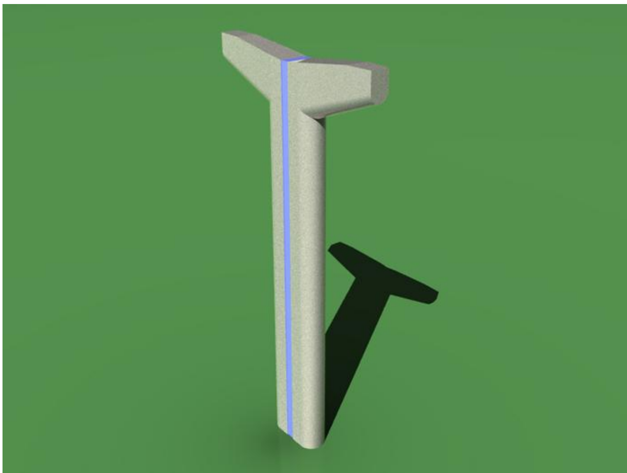
Рис. 4. Внешний вид промежуточной поддерживающей опоры СТЮ
