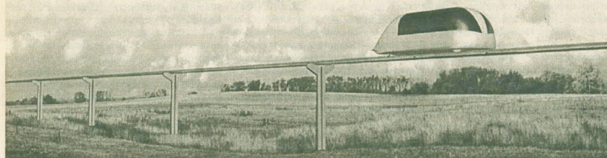
Рис. 1. Высокоскоростной пассажирский модуль СТЮ, скорость до 350 км/ч, вместимость 15...40 чел.
