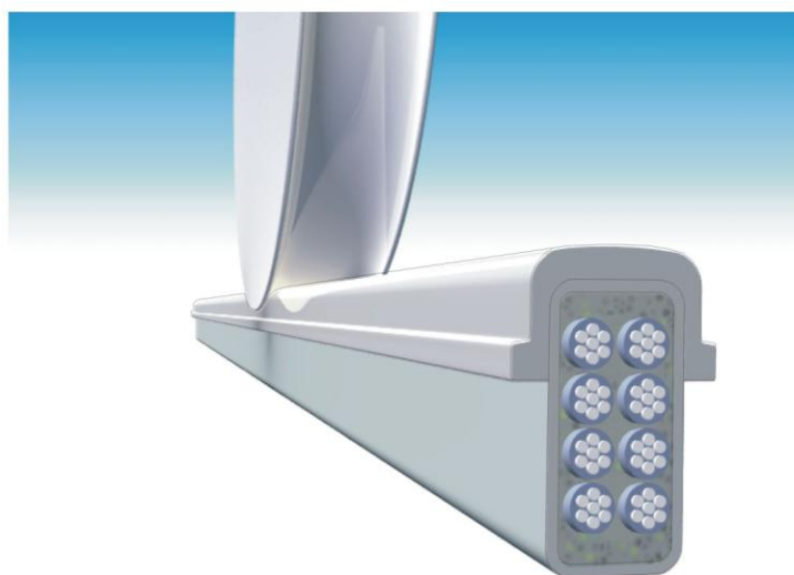
Рис. 9. Колесо на рельсе-струне
