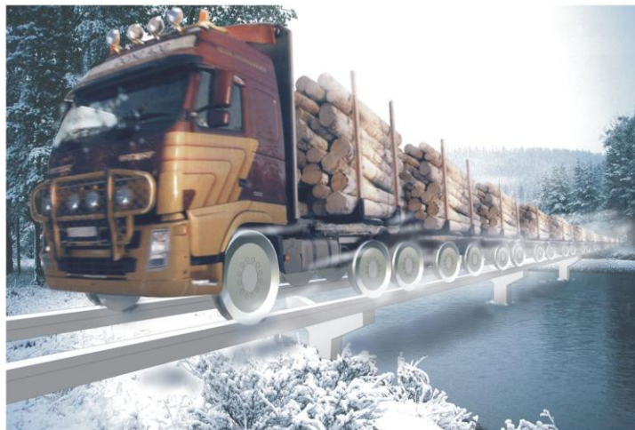
Рис. 3. Грузовой поезд СТЮ на базе серийного грузового автомобиля (масса до 500 т, скорость до 100 км/час)
