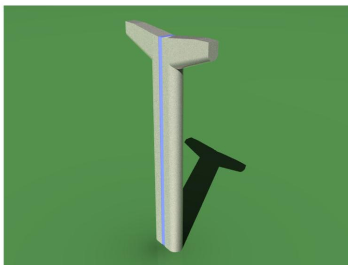
Рис. 8. Промежуточная опора малой высоты однопутной трассы СТЮ
