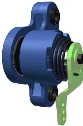
Рис. 1.10. Механический суппорт стояночной тормозной системы
