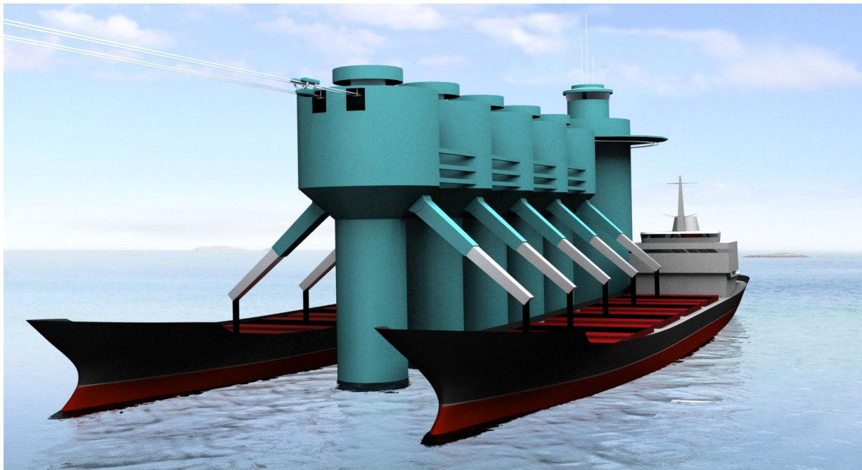
Рис. 3.8. Вариант перегрузки руды в балкер (каждый бункер оснащен своим перегружающим устройством)
