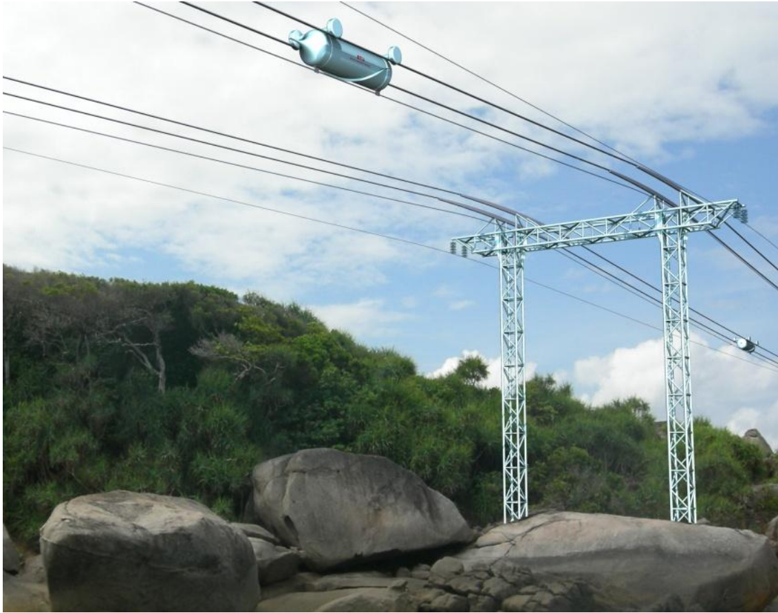
Рис. 1.1. Вариант грузового подвесного СТЮ (с тягой при помощи каната)
