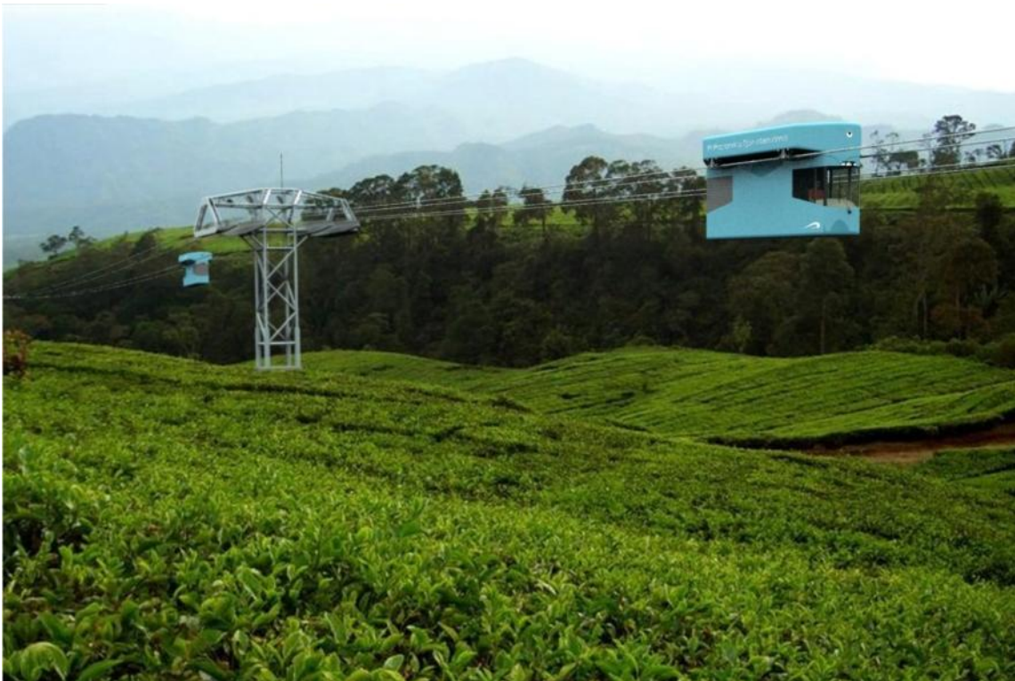
Рис. 1.2. Вариант грузового подвесного СТЮ (подвижной состав — с водителем)
