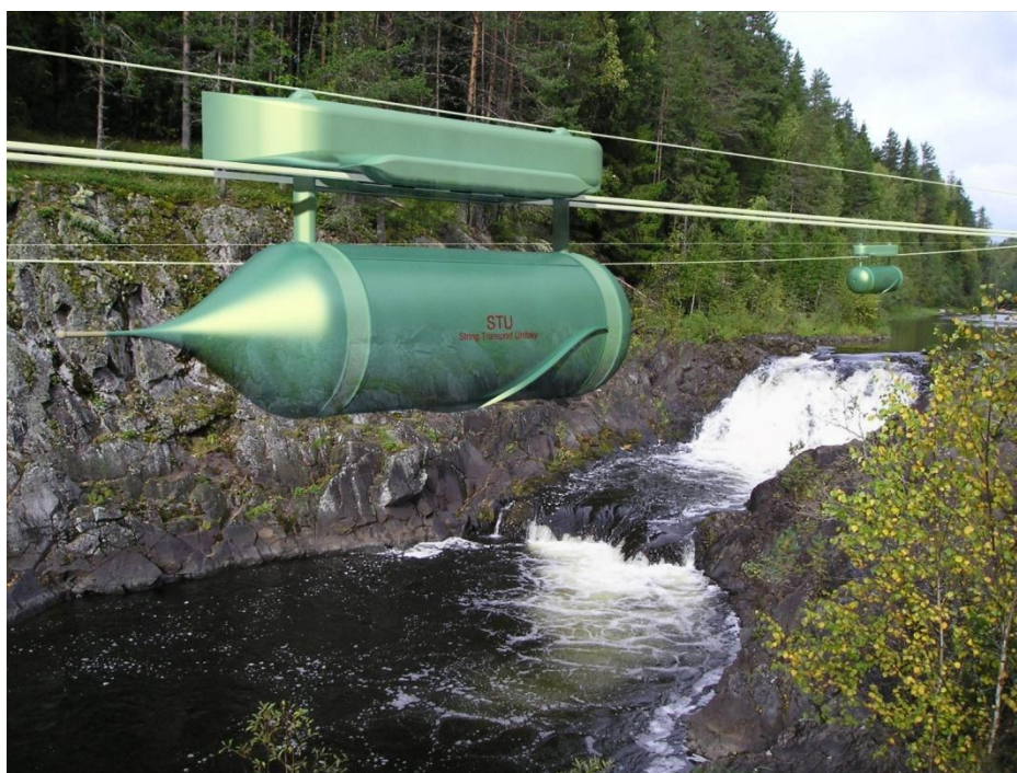
Рис. 27. Грузовой подвесной рельсовый автомобиль ТСЮ грузоподъемностью 10 т (с тяговым канатом)
