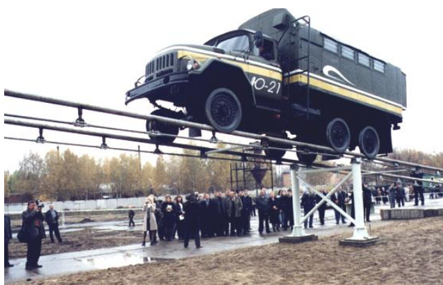
Рис. 46. Модифицированный ЗИЛ-131 на рельсо-струнном пролёте длиной 24 м (октябрь 2001 г.)
