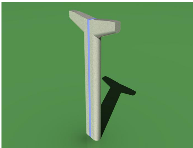
Рис. 21. Промежуточная опора малой высоты однопутного навесного ТСЮ (вариант)
