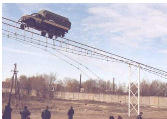
Рис. 47. Модифицированный ЗИЛ-131 на рельсо-струнном пролёте длиной 48 м (ноябрь 2003 г.)
