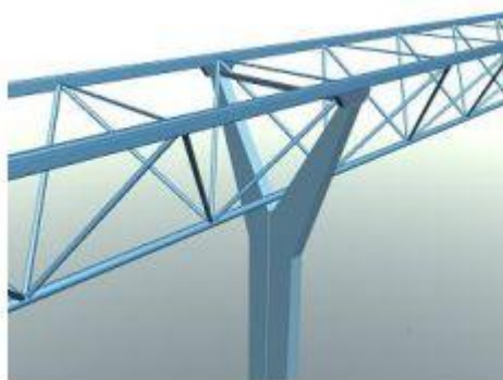
Рис. 5. Рельс-струна выполненная в виде фермы
