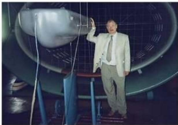
Продувка модели юнибуса в аэродинамической трубе
