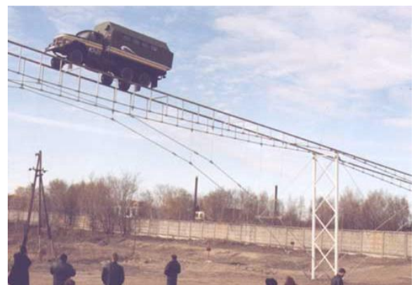
Рис. 47. Модифицированный ЗИЛ-131 на рельсо-струнном пролёте длиной 48 м
