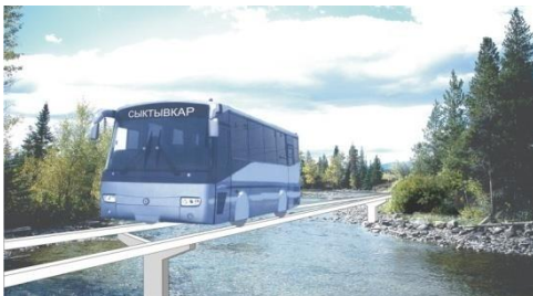
Рис. 9. Автобус на рельсо-струнной путевой структуре
