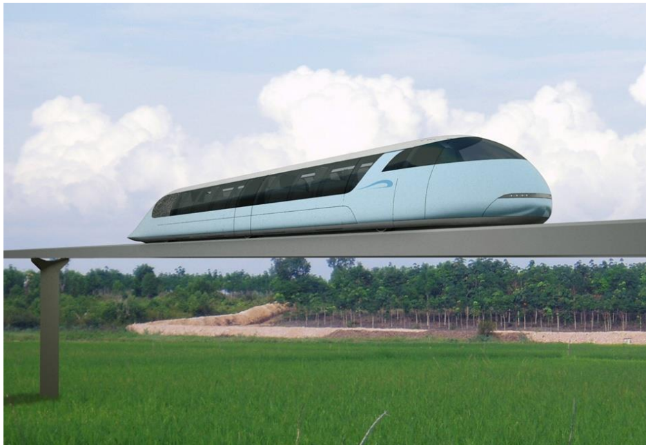
Рис. 26. Пассажирский высокоскоростной юнибус (вместимость 36 пассажиров, расчётная скорость движения 360 км/час)
