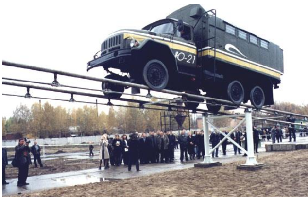
Рис. 46. Модифицированный ЗИЛ-131 на рельсо-струнном пролёте длиной 24 м
