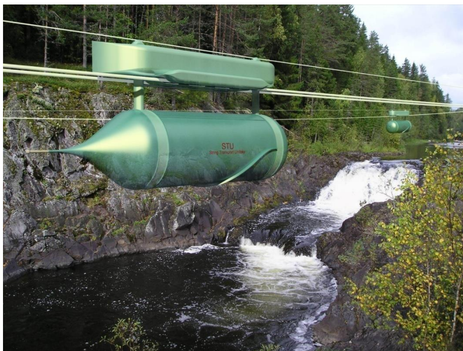
Рис. 27. Грузовой подвесной рельсовый автомобиль SkyWay грузоподъемностью 10 т (с тяговым канатом)
