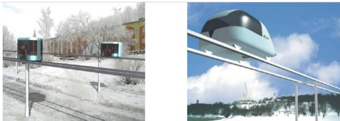
Fig. 20-21 Doppio binario Skyway in città, velocità fino a 150 Km/h. - Binario singolo velocità media 250 Km/h.
