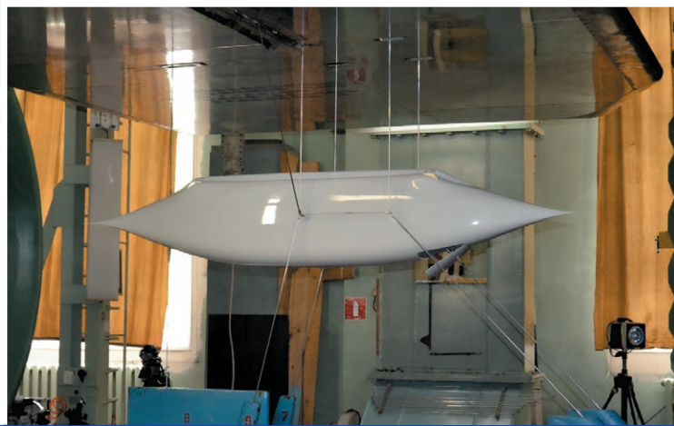
Продувка модели высокоскоростного юнибуса масштаба 1:5 в аэродинамической трубе, 2017 г. →
