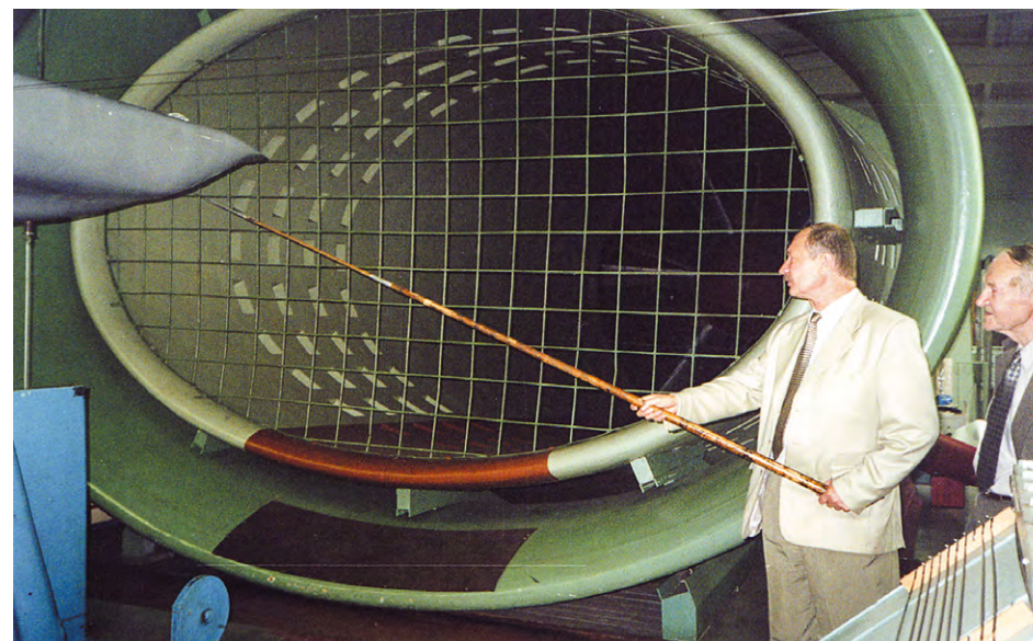
Продувка модели высокоскоростного юнибуса в аэродинамической трубе, г. Санкт-Петербург, август 2001 г.
