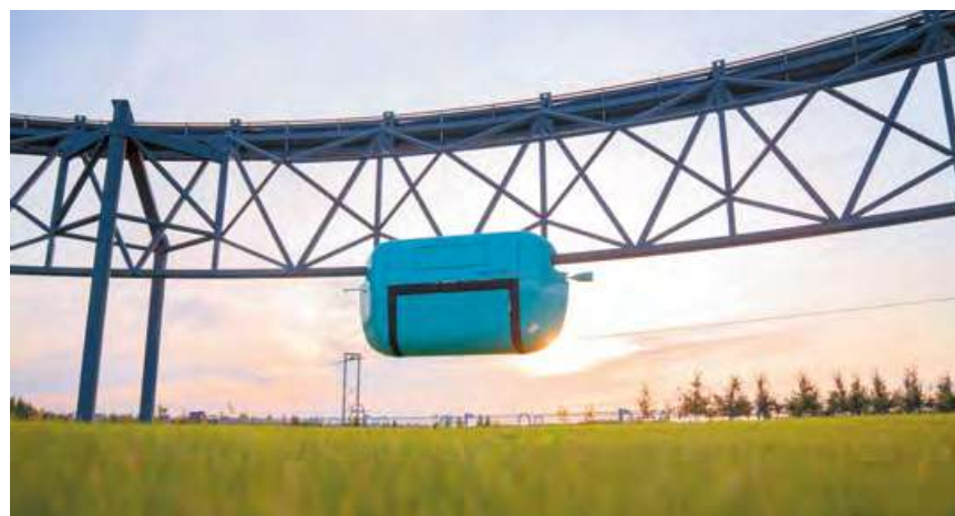
2019 год. ЭкоТехноПарк. Юнивинд – одна из самых простых моделей в линейке подвижного состава струнного транспорта. Грузовой юнитрак, предназначенный для перевозки сыпучих грузов
