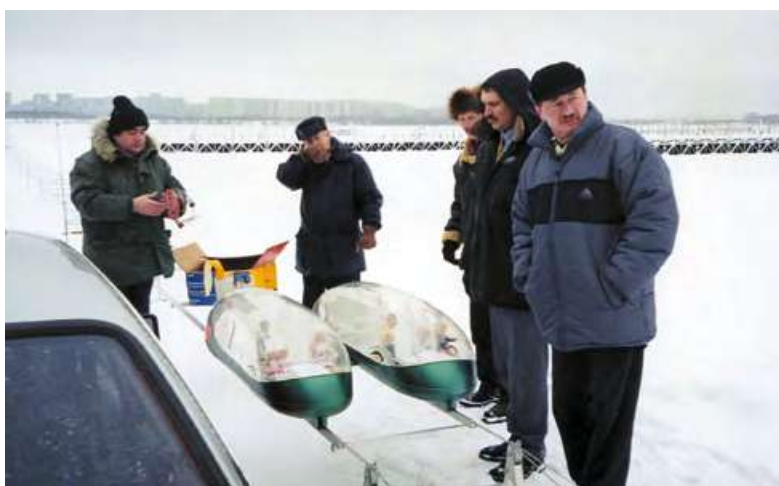
2000 год. Город Москва, аэродром Тушино. Испытания действующей физической модели струнного транспорта с двухкорпусным юнибусом масштаба 1 : 5
