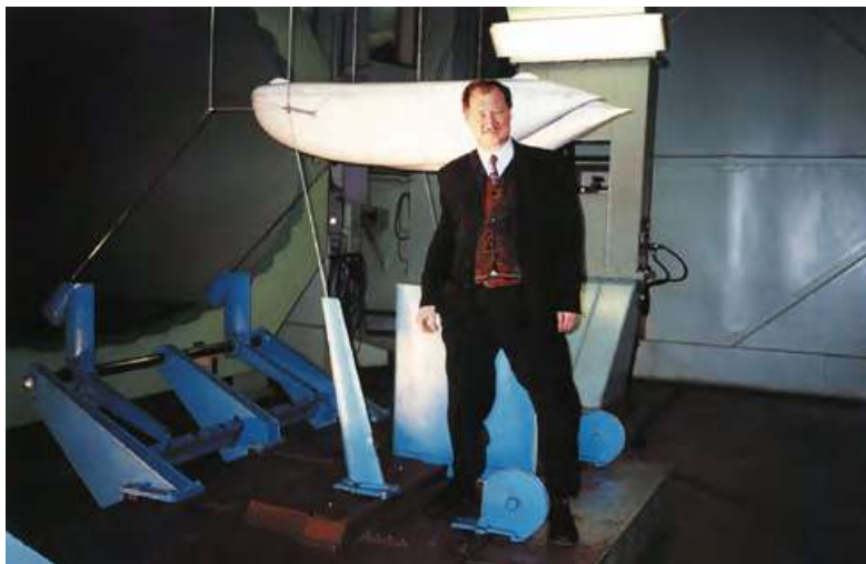
2000 год. Город Санкт-Петербург. Продувка модели двухкорпусного юнибуса масштаба 1 : 5 в аэродинамической трубе
