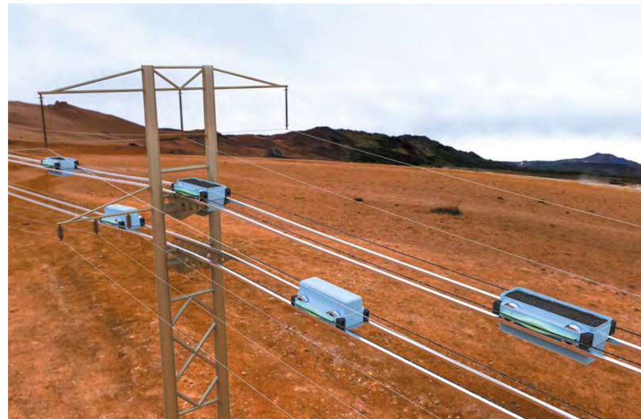
2010 год. Грузовая трасса с канатным приводом в Австралии (визуализация)
