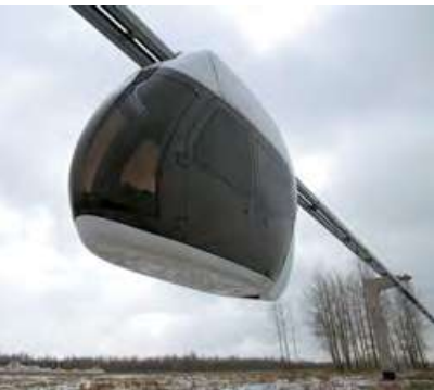
2016 год. ЭкоТехноПарк. Натяжение струнного рельса и начало ходовых испытаний лёгкой транспортной системы и двухместного юнибайка
