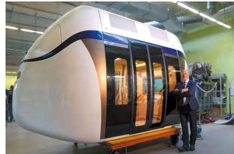
2019 год. Под руководством генерального конструктора ЗАО «Струнные технологии» идут работы по созданию струнного транспорта. Юникар в тропическом исполнении: адаптирован к жаркому климату и повышенной влажности
