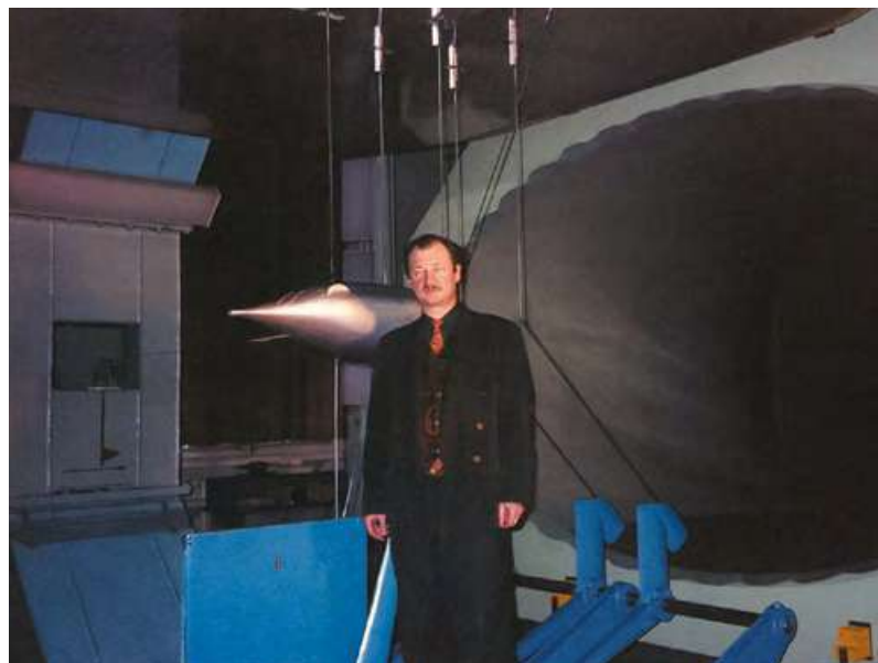
1996 год. Город Санкт-Петербург. Продувка высокоскоростного модуля масштаба 1 : 5 в аэродинамической трубе
