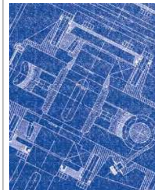
Синька – копия, репродукция технического чертежа, полученная с помощью контактной печати на светочувствительной бумаге. Технология была широко распространена вплоть до конца 1970-х годов. При производстве копий использовались два метода: цианотипия и позже диазотипия. Цианотипия давала изображение белыми линиями на синем фоне. С этим связано название «синька», которое в дальнейшем сохранилось, хотя цвет линий и фона изменился. Диазотипия, упоминаемая Анатолием Юницким, давала тёмные линии на фоне, окрас которого мог варьироваться от розово-сиреневого до чисто-белого.
