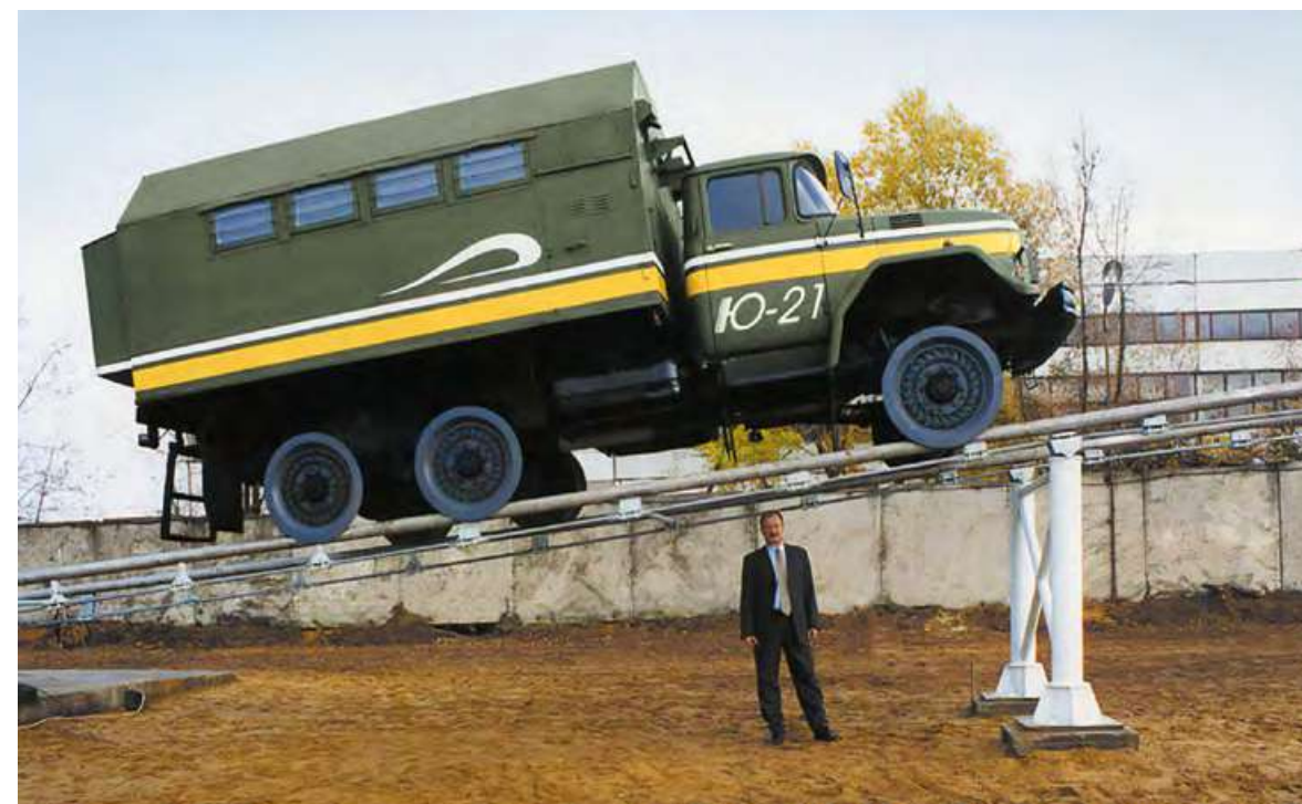
2001 год. Испытания струнного транспорта на Озёрском полигоне. Я демонстрирую надёжность и безопасность системы, стоя под путевой структурой, по которой движется имитатор подвижного состава, созданный на базе грузового автомобиля ЗИЛ-131, массой более 10 тонн
