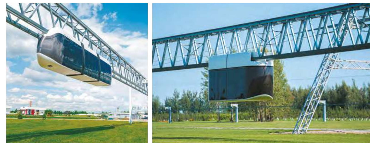
2018 год. ЭкоТехноПарк. 18-местный юникар и 48-местный юнибус на ферменной струнной эстакаде
