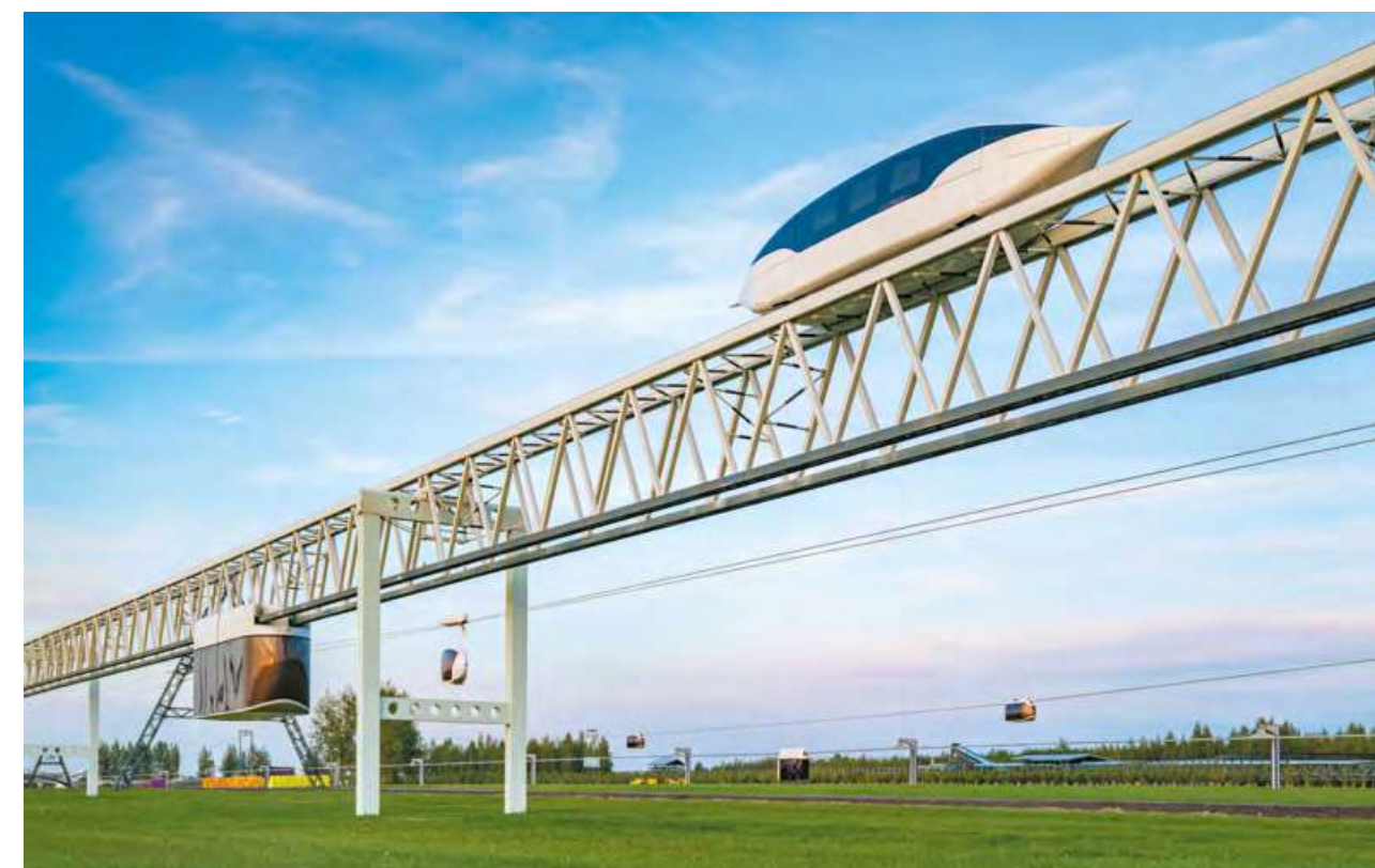
2019 год. ЭкоТехноПарк. Различные виды подвижного состава струнного транспорта – шесть юнимобилей (включая высокоскоростной транспортный модуль) – на различных типах струнных эстакад
