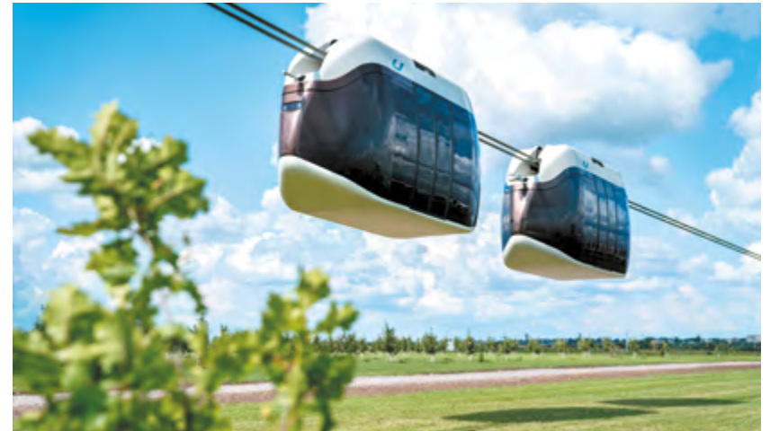
2019 г., Марьина Горка. R&D-центр «ЭкоТехноПарк»: пример функционирования струнного транспорта «второго уровня» – юнимобили в электронной сцепке
