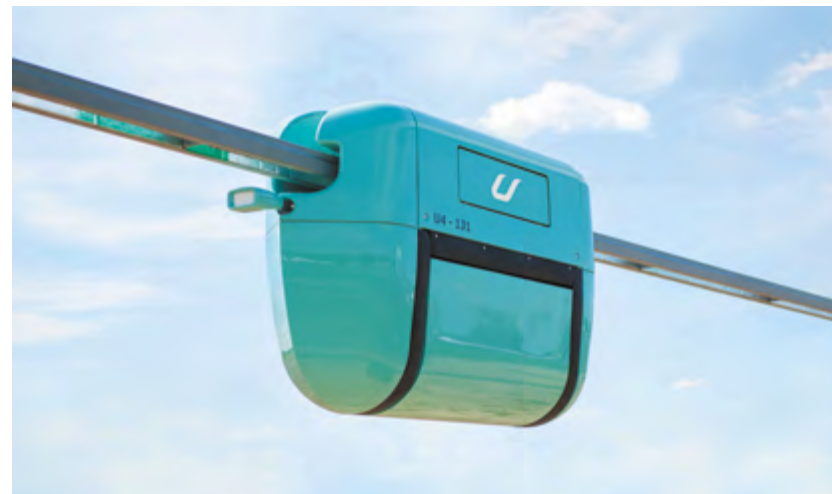
2019 г., Марьина Горка. R&D-центр «ЭкоТехноПарк»: юнитрак – грузовое транспортное средство, предназначенное для использования на промышленных объектах, в портах и местах добычи полезных ископаемых, а также для доставки угля на солнечные реликтовые биоэлектростанции линейных городов
