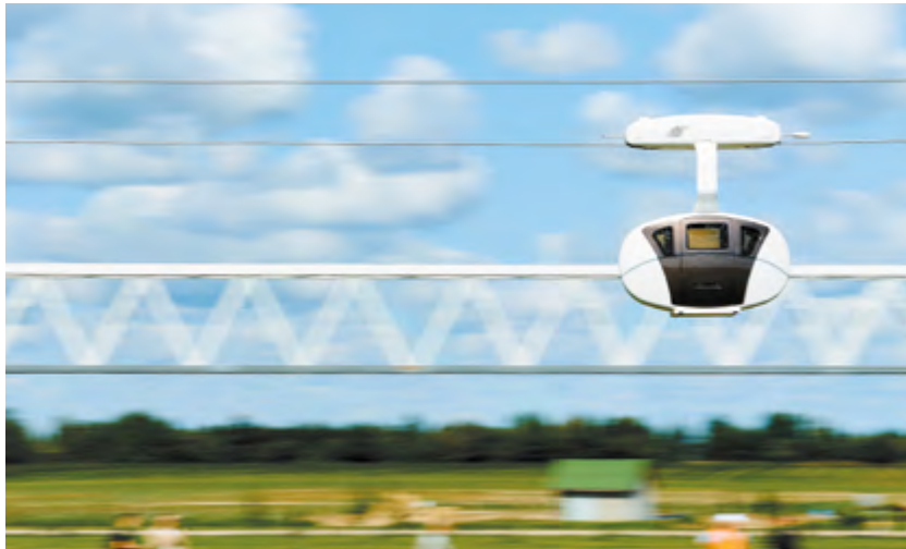
2019 г., Марьина Горка. R&D-центр «ЭкоТехноПарк»: юнивинд – наиболее доступное из линейки реализованного подвижного состава транспортное средство, предназначенное для сообщения с малонаселёнными, отдалёнными районами на линиях с небольшим пассажиропотоком
