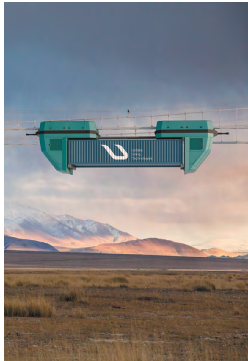
Конструкция юниконта позволяет транспортировать крупногабаритные контейнеры любого типа без дополнительной перегрузки
