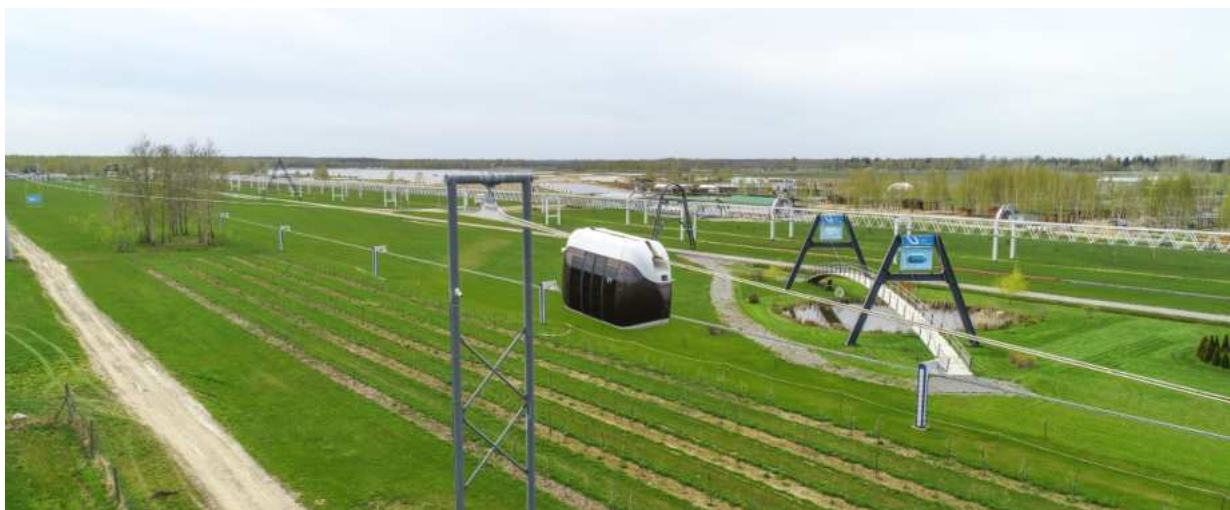
Рис. 6. ЭТП, Юникар на гибкой рельсо-струнной эстакаде
