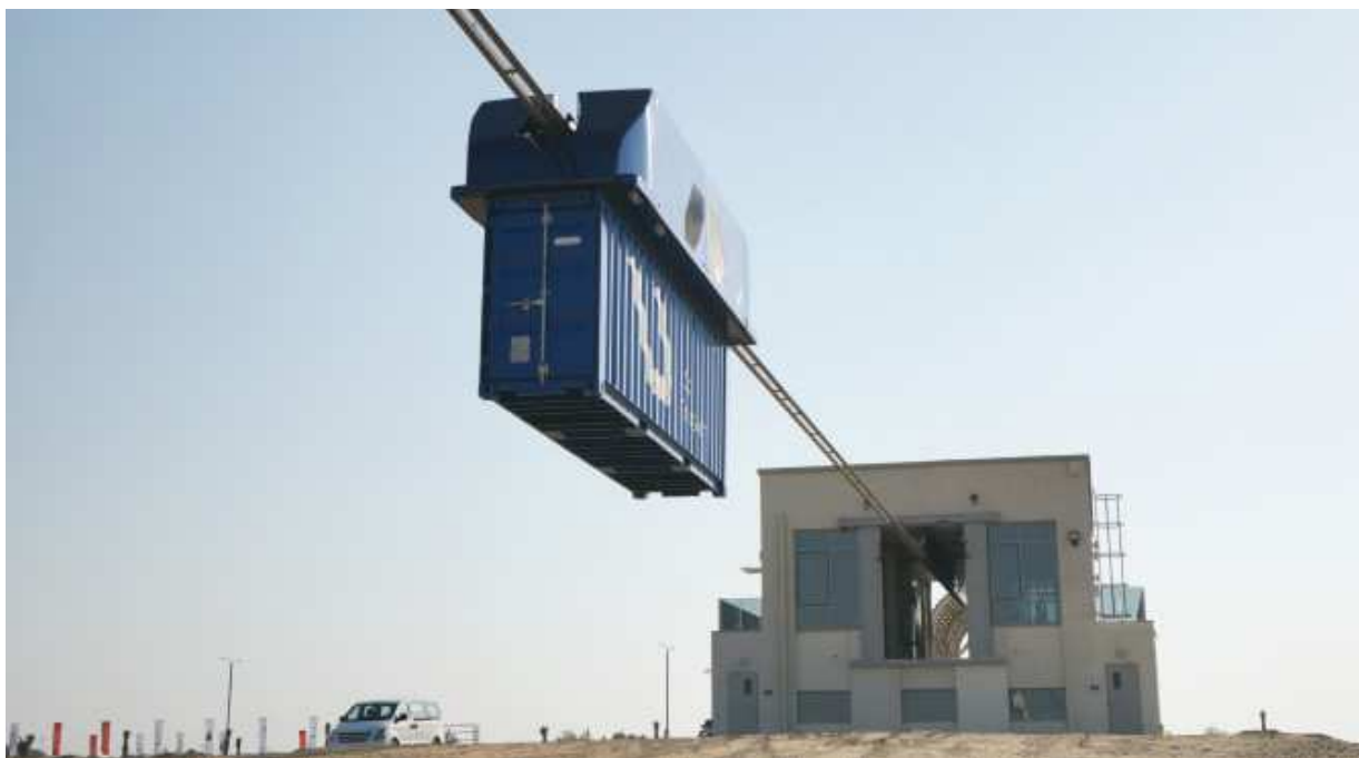
Рис. 12. Грузовое транспортное средство – навесной Юниконт (Центр испытаний и сертификации uSky (Шарджа, ОАЭ))
