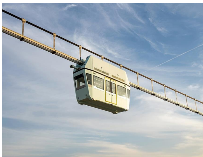
Рисунок 1 - Путевая структура uST с пассажирским транспортным средством модели «Карат» (Шарджа, ОАЭ, 2023 г.)
