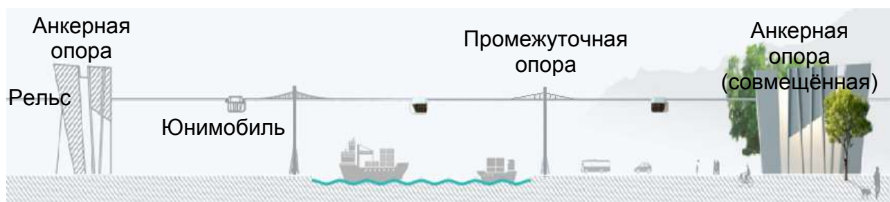
Рисунок 1 – Транспортно-инфраструктурный комплекс рельсо-струнного транспорта uST подвесного типа
