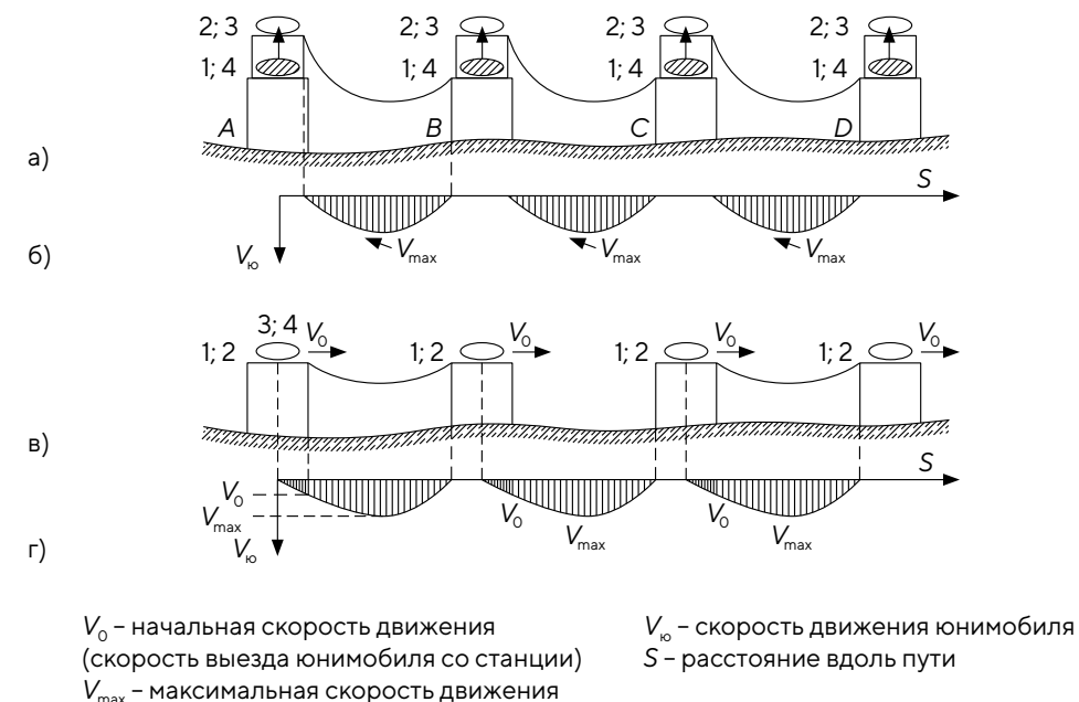
Рисунок 2 – Схема движения юнимобилья: а – между разноуровневыми станциями, размещёнными на крышах зданий A, B, C и D ; б – эпюры скоростей движения между разноуровневыми станциями; в – между станциями, размещёнными на одном уровне (высоте); г – эпюры скоростей движения между станциями, размещёнными на одном уровне (высоте); 1, 2 – уровни прибытия на станцию и убытия со станции юнимобилья соответственно; 3, 4 – юнимобилья на станции в положении убытия и прибытия соответственно
