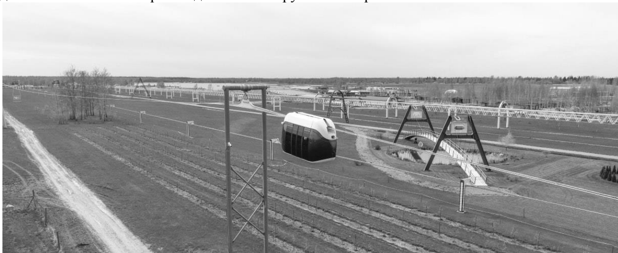
Рис. 11. Юнимобиль на гибкой рельсо-струнной эстакаде, ЭкоТехноПарк, г. Марьина Горка (Беларусь)
