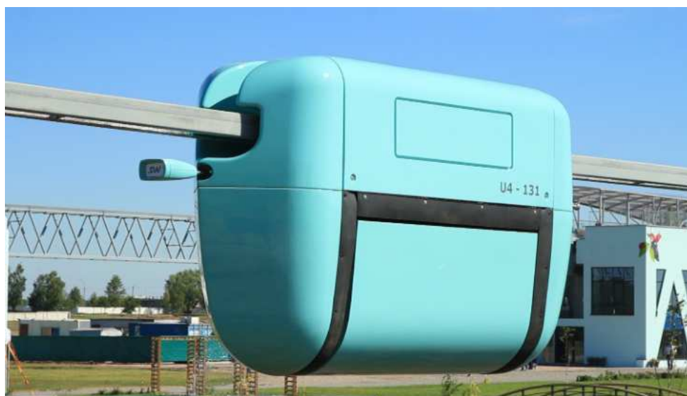
Рис. 13. Грузовое транспортное средство – подвесной Юнитрак (ЭТП, Марьина Горка, Беларусь)
