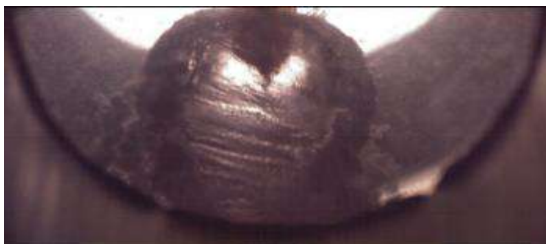
Рисунок 5 – Изображение кавитационного пузыря при протекании электрогидравлического удара в жидкости
