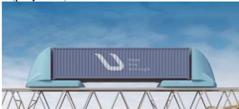
Рисунок 3 – Грузовой юнимобиль – навесной юниконт
