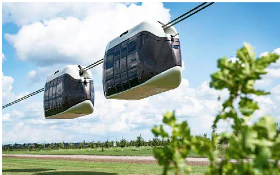
Шестиместные юникары У4-430 движутся в электронной сцепке
